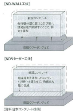
図4 ■ 壁体下端の拘束を低減
