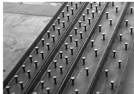
写真-1 I 形鋼にスタッド配置した補強材
