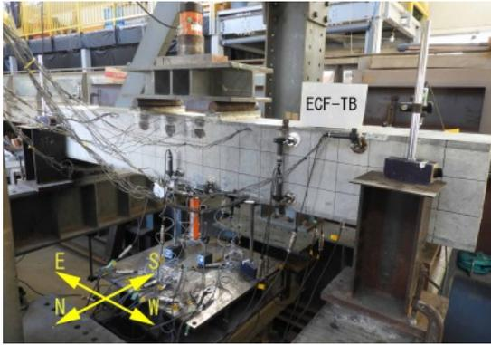
写真-2 梁載荷実験状況 (ECF-TB)
