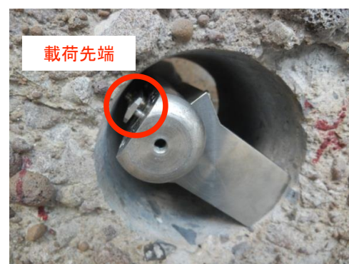
写真-3 孔内載荷試験装置
