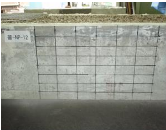
写真-2 テストハンマー打撃位置の一例(普-NP-12)
