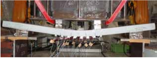
写真-6 供試体の載荷終了時の変形状況
