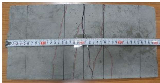
写真-3 曲げひび割れの分散状況
