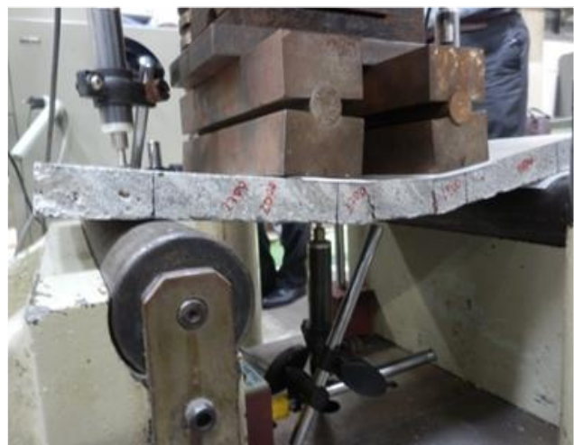
写真-2 小型パネルの曲げ試験実施状況 (大変形が生じても破壊に至らず)
