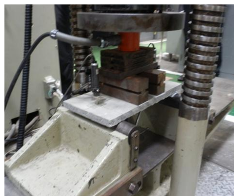
写真-2 曲げ試験の載荷状況(開始時)
