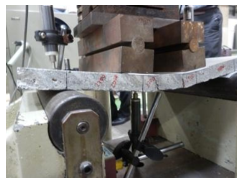
写真-3 曲げ試験の載荷状況(終了時)
