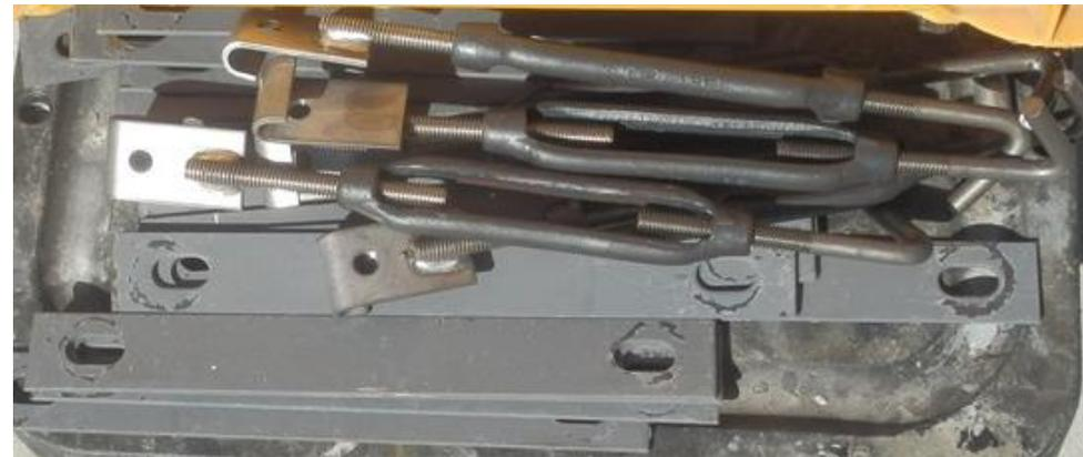
トラス治具と内部支保工(セパレーター)の接合状況
