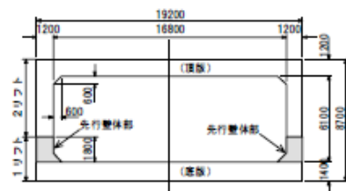
図-2 ボックスカルバートの断面の形状寸法
