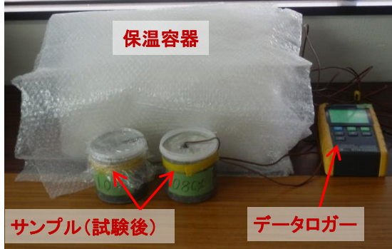
保温容器内にサンプルを入れて温度を測定
